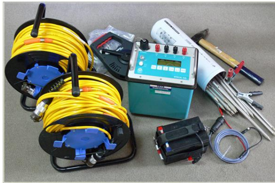
Slika 10. Terenska oprema za geoelektrična ispitivanja
